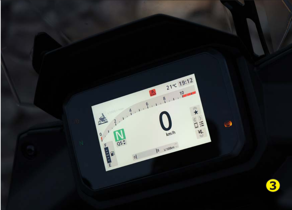
●1)La mecánica y la electrónica no se han modificado, pero sí la regulación de las suspensiones .●2)Motor bicilíndrico de 755 cc 4T refrigerado por líquido de 92 CV y 75 Nm. ●3)Nueva pantalla TFT de 5" con conectividad
