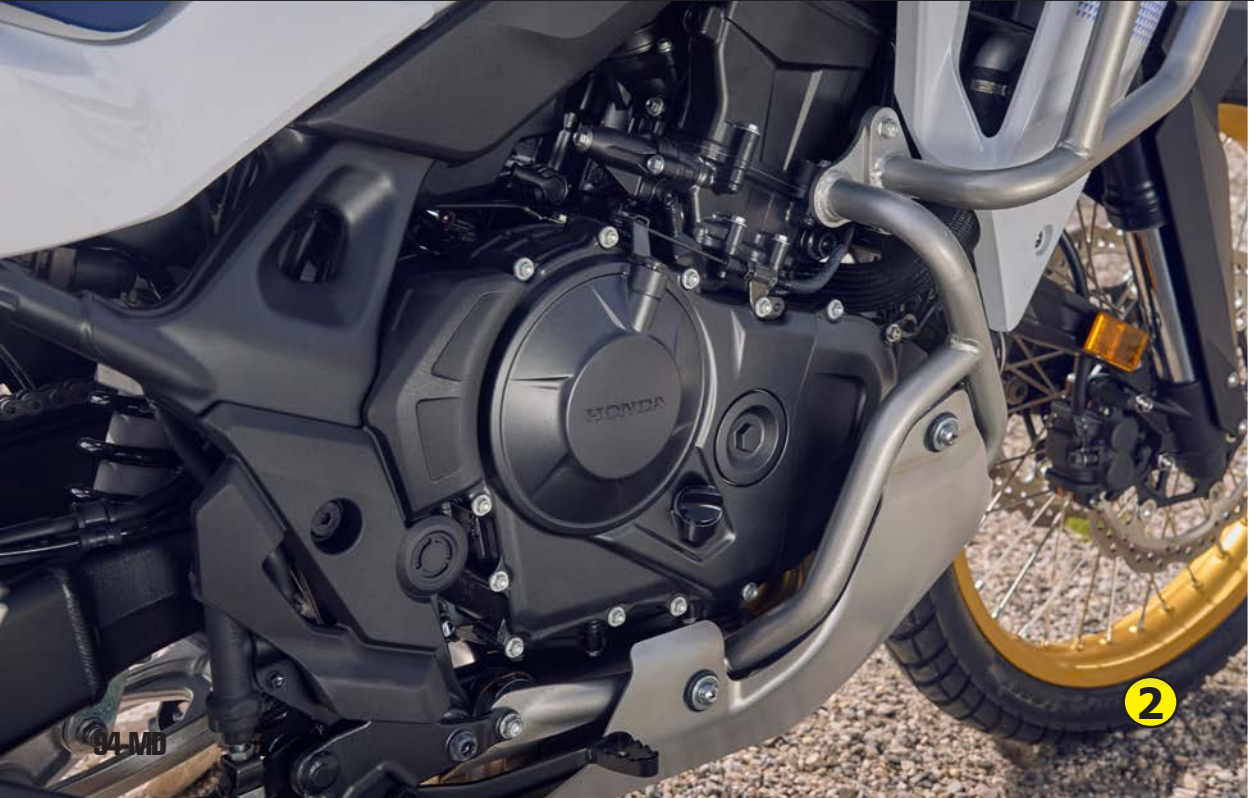
●1)La mecánica y la electrónica no se han modificado, pero sí la regulación de las suspensiones .●2)Motor bicilíndrico de 755 cc 4T refrigerado por líquido de 92 CV y 75 Nm. ●3)Nueva pantalla TFT de 5" con conectividad
