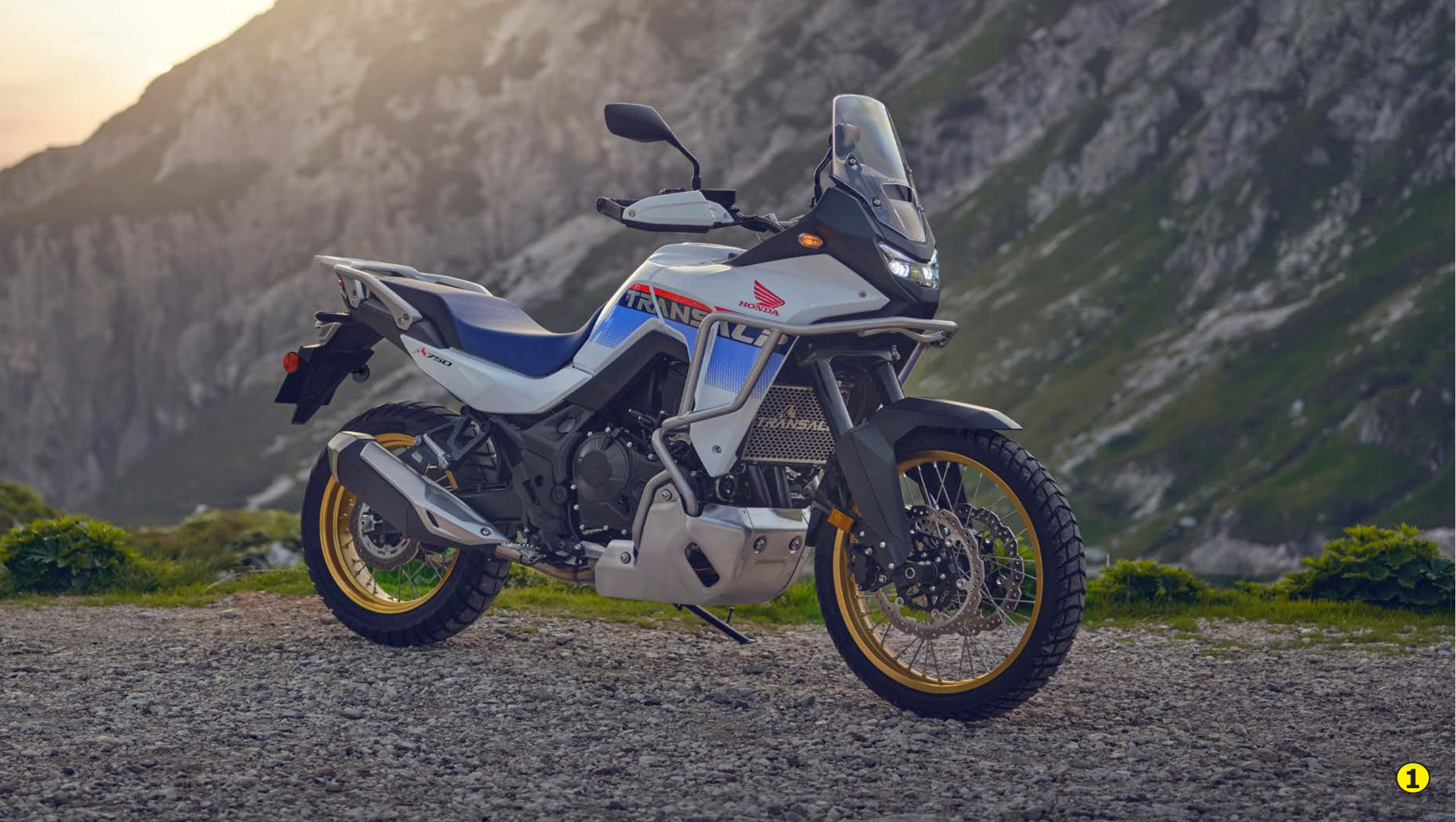
●1)La mecánica y la electrónica no se han modificado, pero sí la regulación de las suspensiones .●2)Motor bicilíndrico de 755 cc 4T refrigerado por líquido de 92 CV y 75 Nm. ●3)Nueva pantalla TFT de 5" con conectividad
