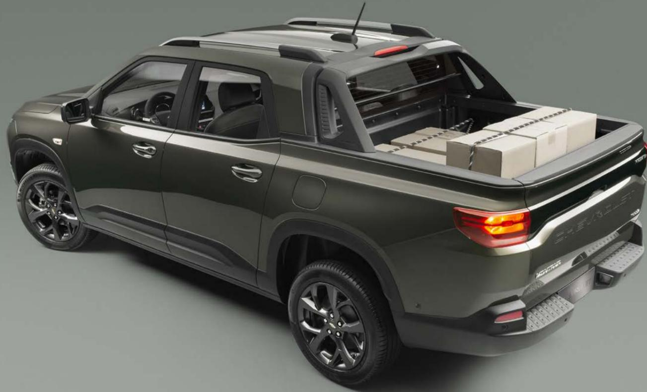
La capacidad de la caja de carga Multi-Flex de la nueva Montana es de 874 litros
