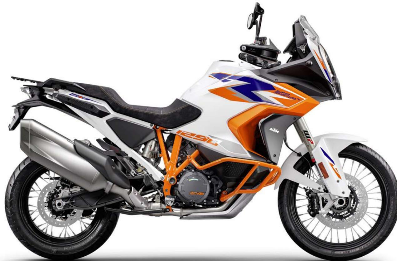
y 1301 cc (108 x 71 mm de diámetro y carrera, respectivamente), el cual entrega una potencia máxima de 160 CV a 9000 rpm, con un par motor máximo de 138 Nm a 6500 rpm.
