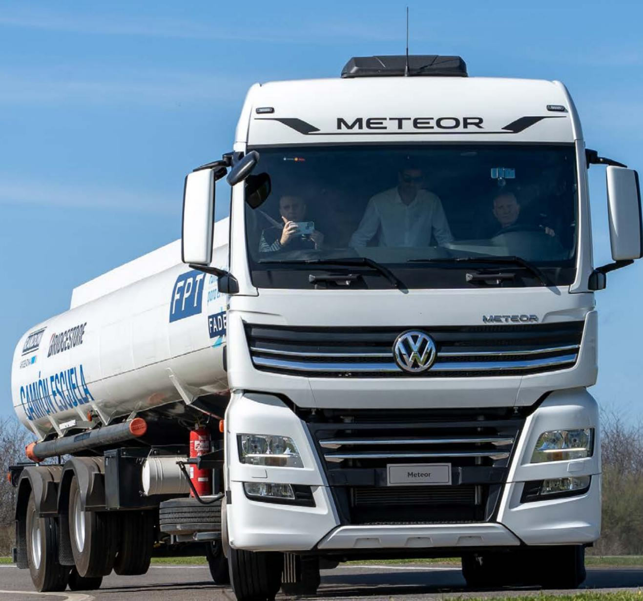
Volkswagen amplió la línea Meteor con el modelo 29.520 con doble eje trasero propulsor y hasta 80.000 kg de capacidad de tracción, equipado con motor MAN de 13 L y 520 CV de potencia
