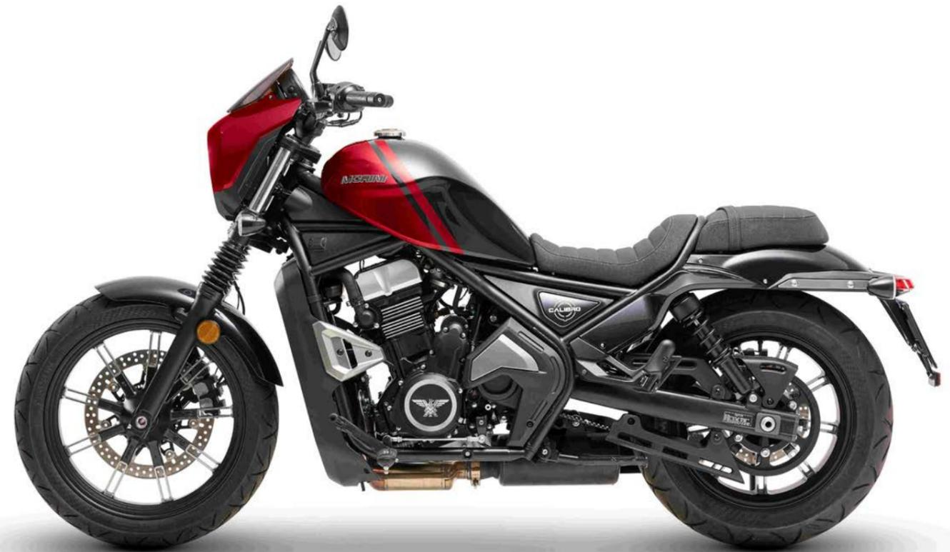
●La Moto Morini Calibro cuenta con un chasis doble cuna. ●La horquilla delantera tiene barras de 41 mm y 120 mm de recorrido. ●La trasera es mediante dos amortiguadores con 100 mm de recorrido y horquilla
