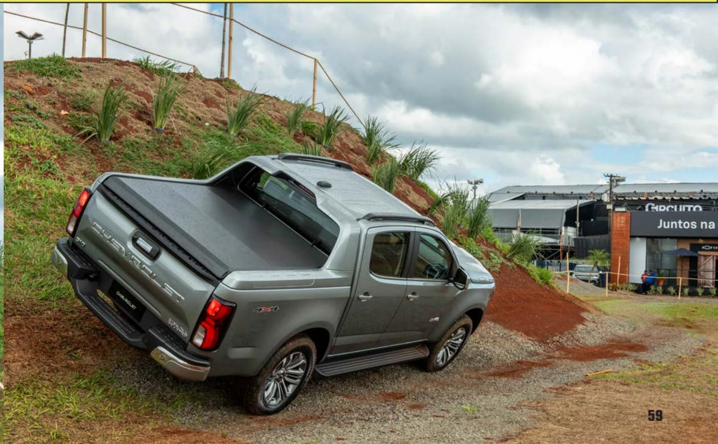
●La Chevrolet S10 está equipada con el motor Duramax 4 en línea 2.8 L turbodiésel que entrega 207 CV a 3200 rpm y un torque de 510 Nm en las versiones AT y 460 Nm en las MT a 2000 rpm. ●La transmisión automática es nueva de 8 velocidades y ofrece también manual de 6 marchas. ●Tracción 4x2 y 4x4
