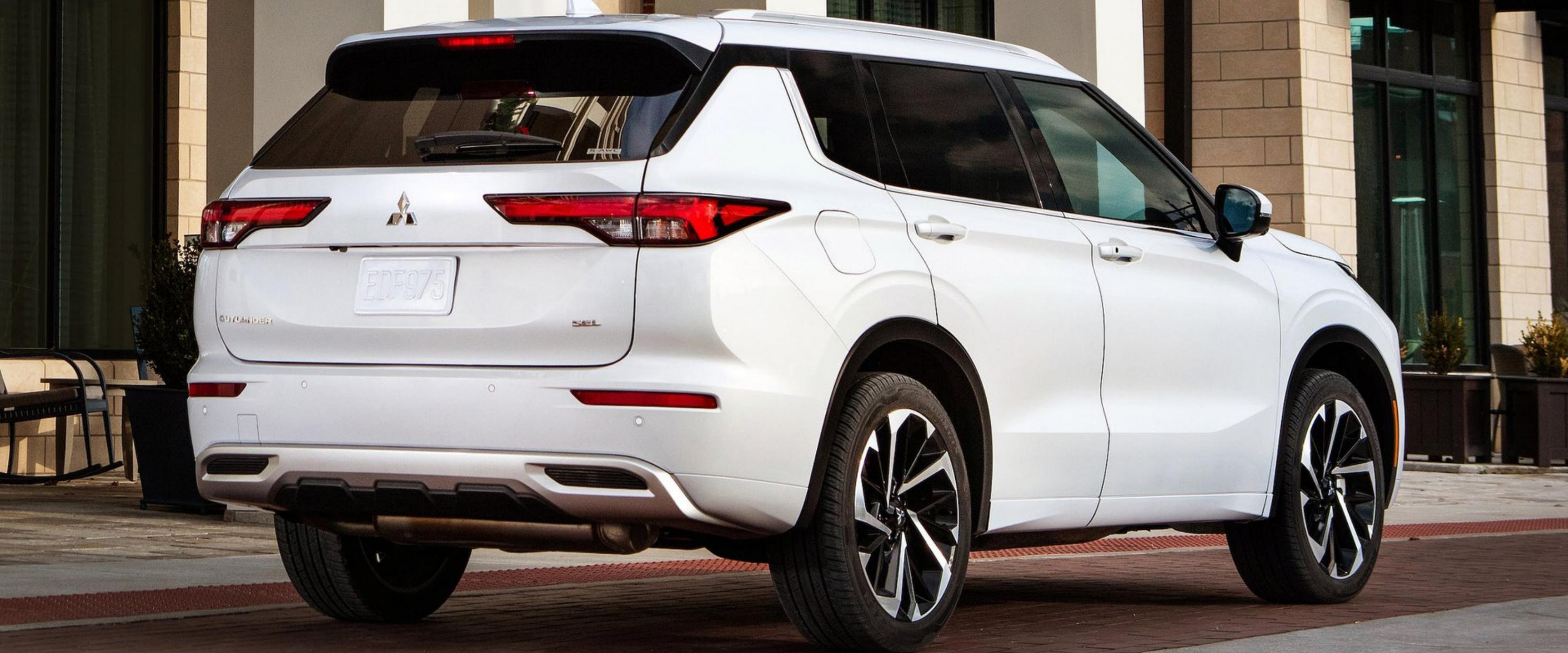
Las medidas del nuevo Outlander son 4710 mm de largo, 1897 mm de ancho, 1745mm de alto y la distancia entre ejes es 2706 mm. El despeje del suelo es de 210 mm, el peso neto 1690 kg y el peso bruto, 2355 kg. El radio de giro es de 5,5 m y la capacidad del baúl es de 331 litros.
