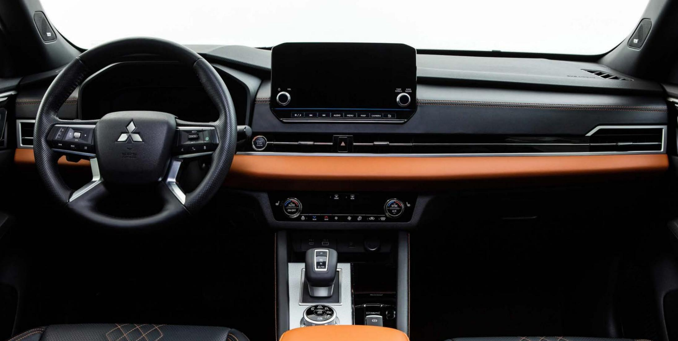
•El interior ofrece un tablero multifunción de 12,3". •1) Dial para seleccionar los modos de conducción. •2)El sistema multimedia con pantalla flotante de 9" incluye navegador nativo (GPS), Android Auto y Apple CarPlay
