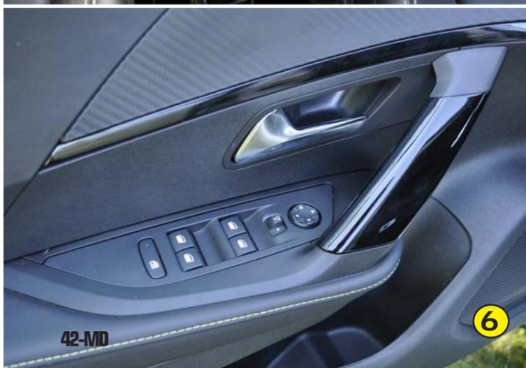
• 1) Volante oval multifunción Sport Drive. • 2) Pantalla táctil de 10,3" con cámara 360°. • 3) Consola central con tecla del freno de estacionamiento. • 4) Selectora convencional de la caja CVT. • 5) Portón amplio y piso bajo del baúl, ideal para cargar. • 6) Comandos de espejos y ventanillas en la puerta del conductor. • 7) Gran tablero 100% digital y configurable. • 8) "Pianito" de variadas teclas físicas
