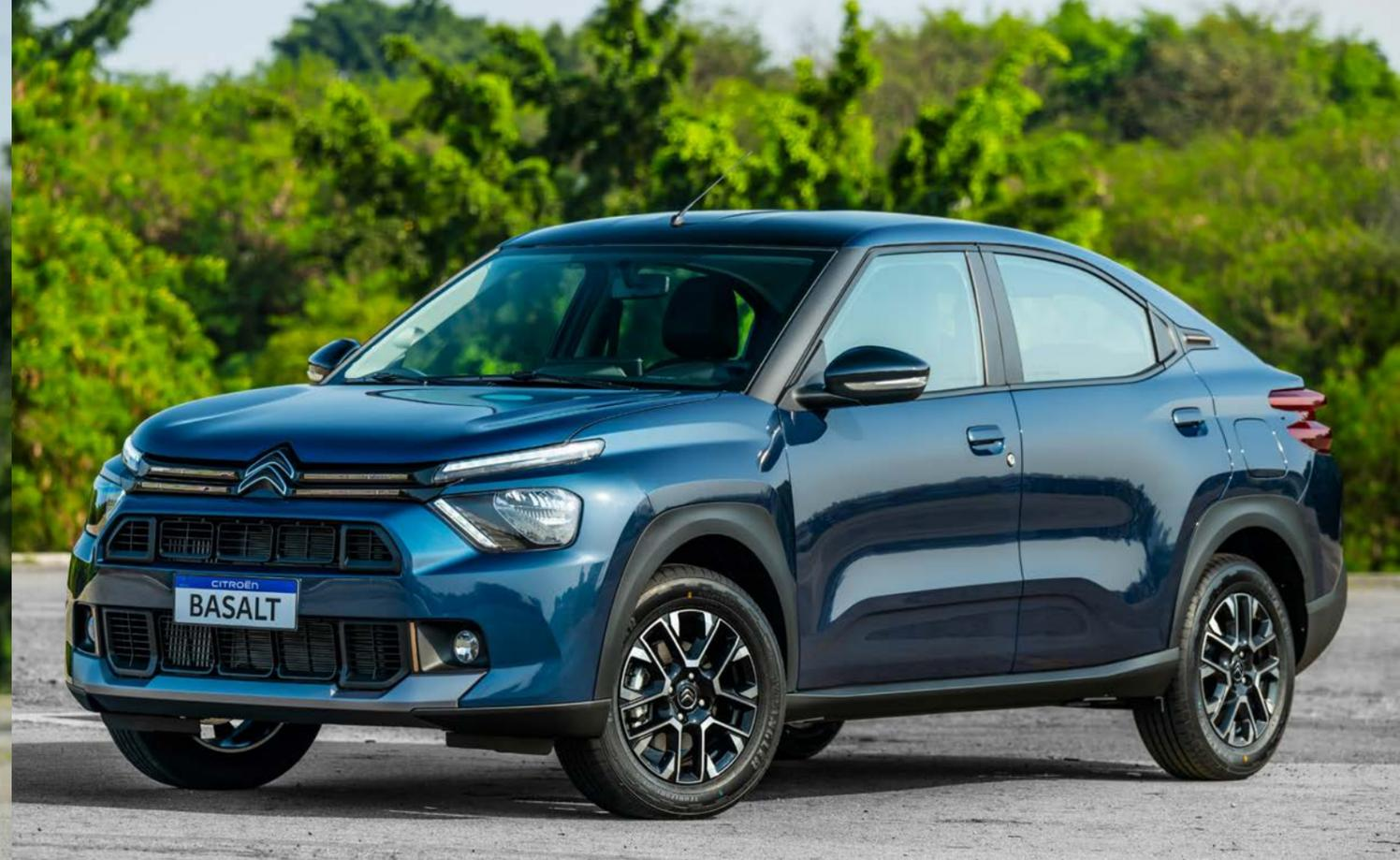
• Basado en la plataforma CMP de Stellantis tiene 4343 mm de largo y 2645 mm de entre ejes. • Estas dimensiones aseguran una excelente habitabilidad, que se ve realzada por un baúl de 490 L. • La gama cuenta con los conocidos motores nafteros 1.6 L VTi de 115 CV y el T200 1.0 L de 120 CV
