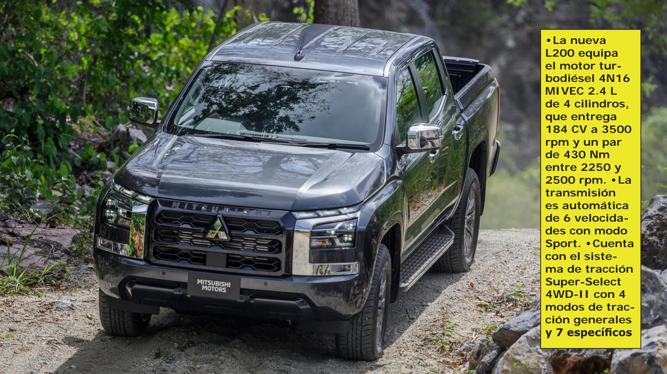
• La nueva L200 equipa el motor turbodiésel 4N16 MIVEC 2.4 L de 4 cilindros, que entrega 184 CV a 3500 rpm y un par de 430 Nm entre 2250 y 2500 rpm. • La transmisión es automática de 6 velocidades con modo Sport. • Cuenta con el sistema de tracción Super-Select 4WD-II con 4 modos de tracción generales y 7 específicos
