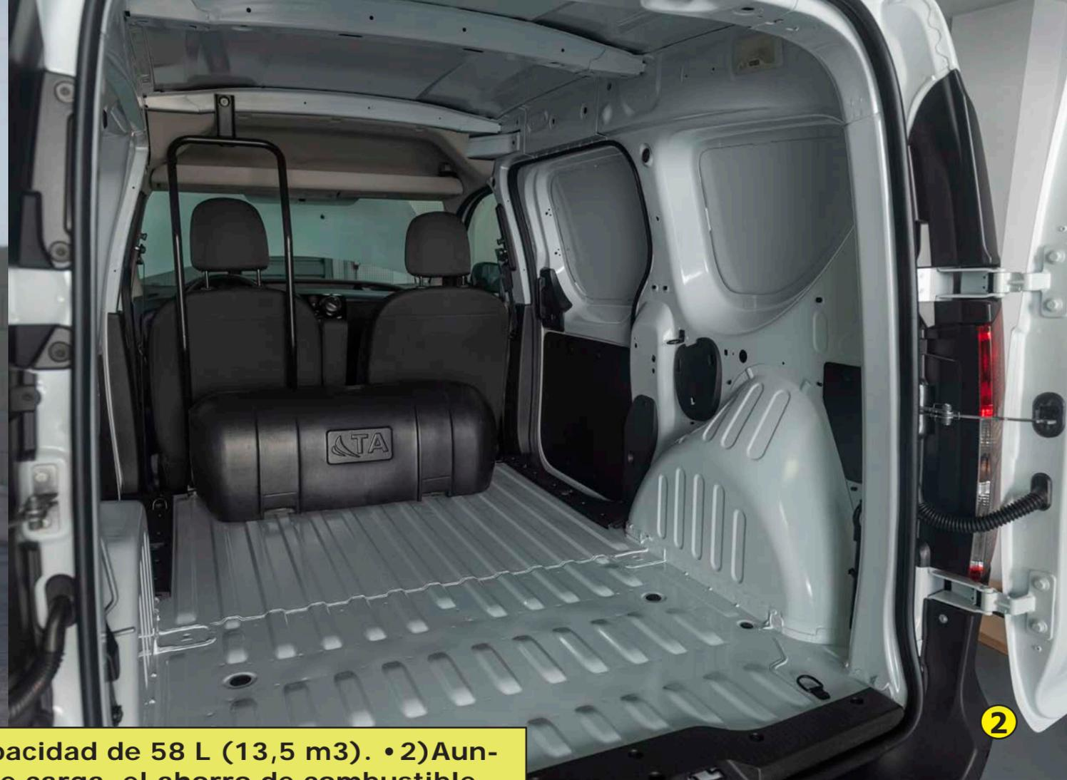
• 1) El cilindro de GNC tiene una capacidad de 58 L (13,5 m<sup>3</sup>). • 2) Aunque reduce un tanto la capacidad de carga, el ahorro de combustible incrementa la rentabilidad. • 3) Válvula de carga del equipo TA GAS
