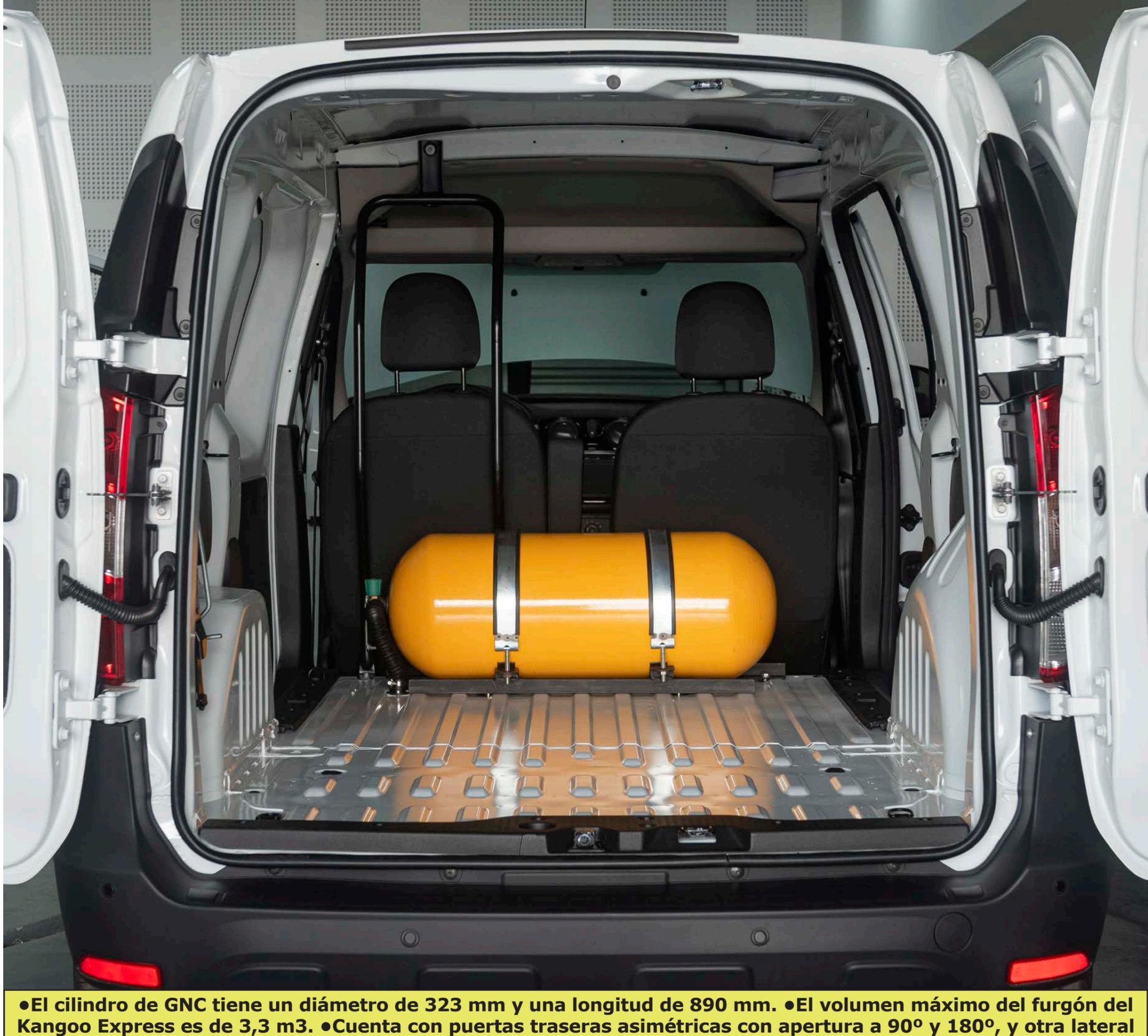
●El cilindro de GNC tiene un diámetro de 323 mm y una longitud de 890 mm. ●El volumen máximo del furgón del Kangoo Express es de 3,3 m3. ●Cuenta con puertas traseras asimétricas con apertura a 90° y 180°, y otra lateral
