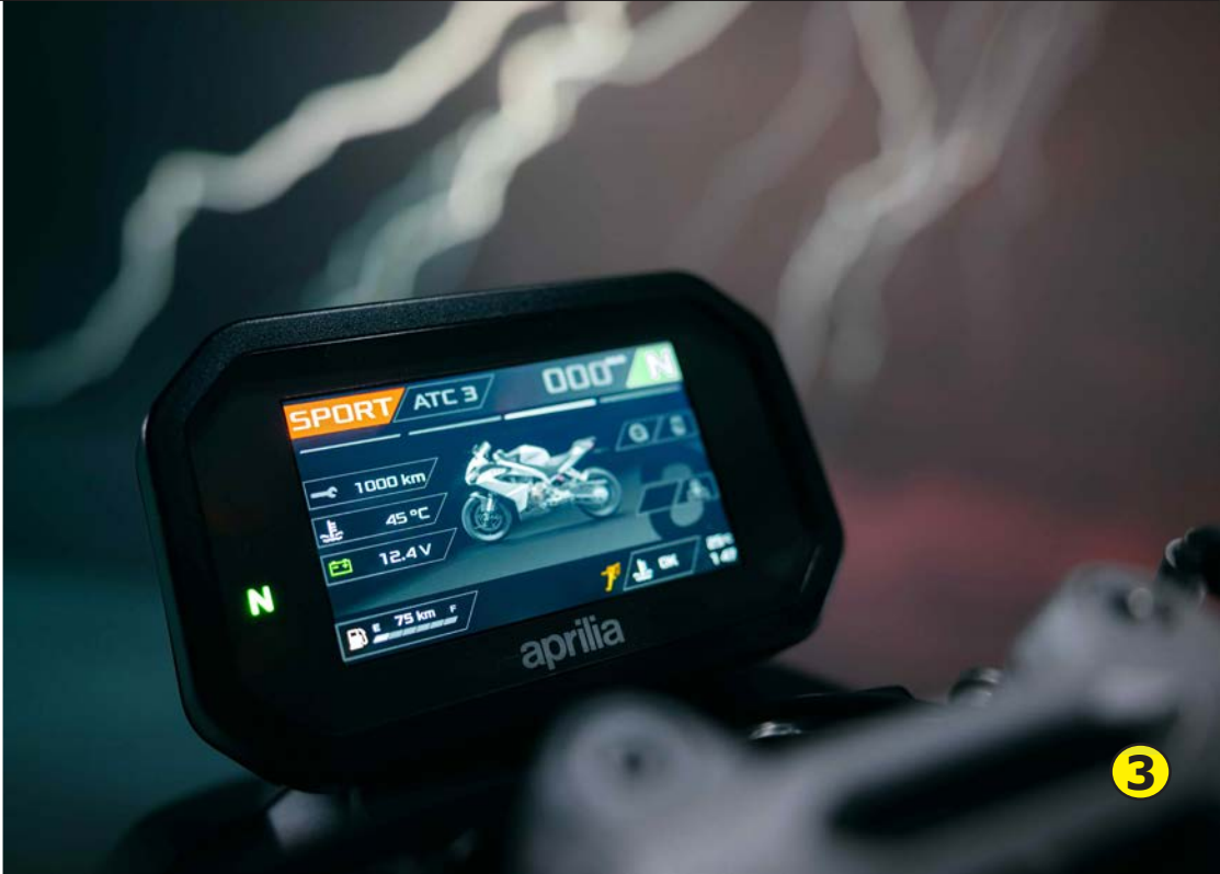
• 1) Las Aprilia 457 son las únicas en su segmento con chasis doble viga de aluminio como los de competición. • 2) Basculante trasero de doble brazo con amortiguación monoshock. • 3) Cluster de instrumentos TFT de 5 pulgadas
