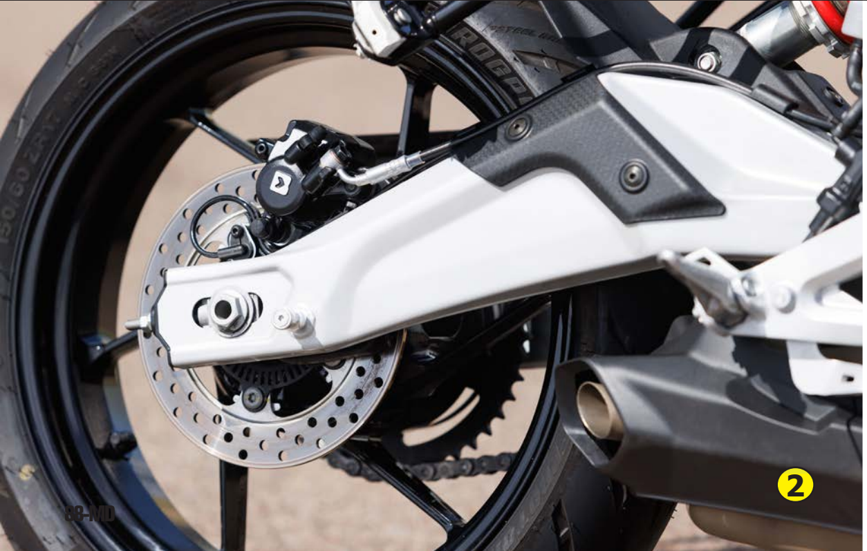
• 1) Las Aprilia 457 son las únicas en su segmento con chasis doble viga de aluminio como los de competición. • 2) Basculante trasero de doble brazo con amortiguación monoshock. • 3) Cluster de instrumentos TFT de 5 pulgadas
