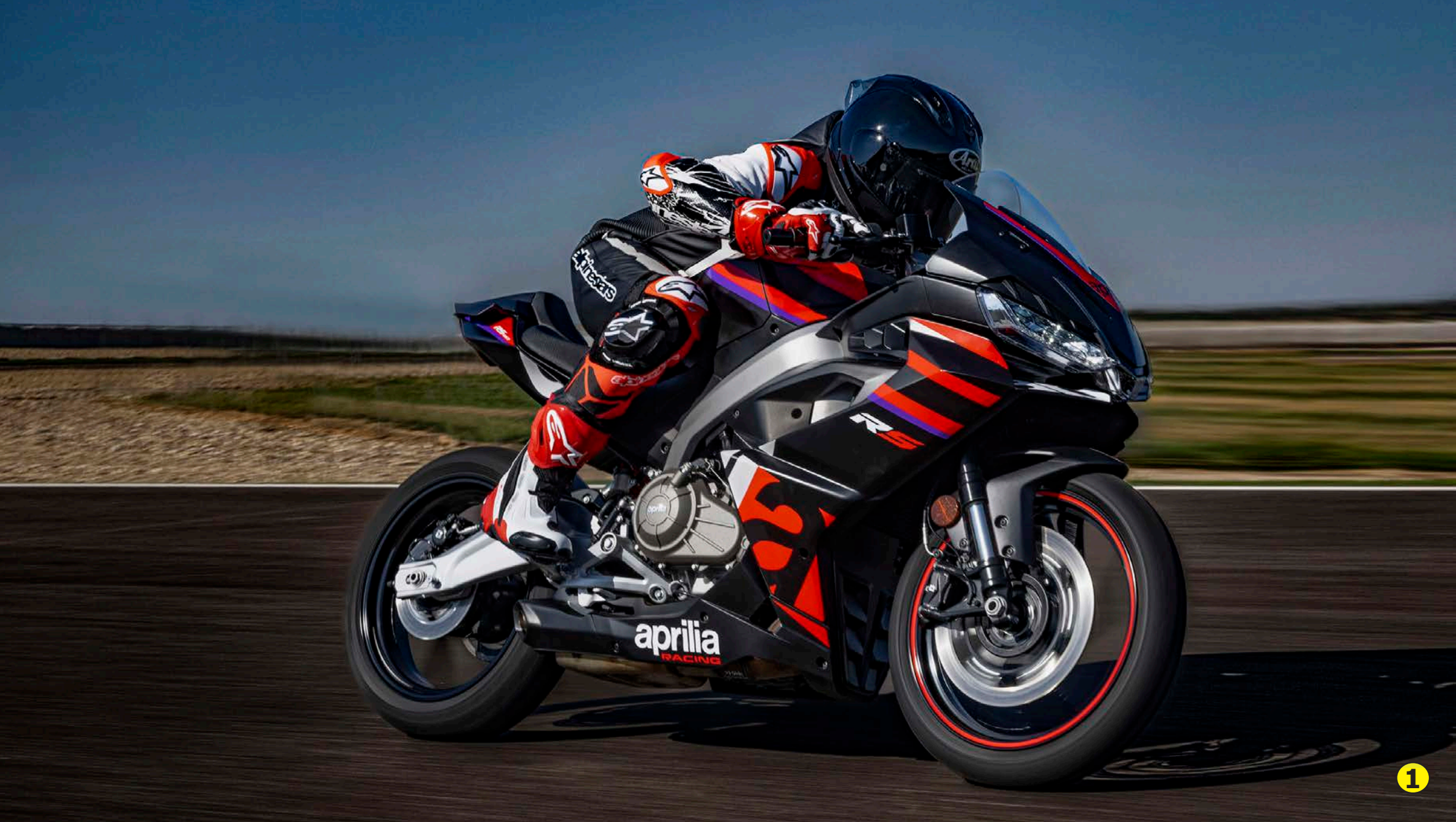
• 1) Las Aprilia 457 son las únicas en su segmento con chasis doble viga de aluminio como los de competición. • 2) Basculante trasero de doble brazo con amortiguación monoshock. • 3) Cluster de instrumentos TFT de 5 pulgadas
